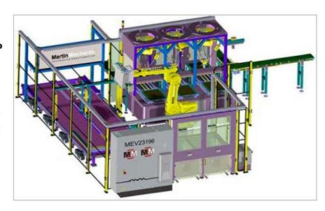
Dazu werden immer vier Bleche direkt aus der vorgelagerten Presse alle vier Sekunden auf dem Transportband der Arbeitszelle abgelegt. Je nach einer der vier möglichen Varianten haben sie zwischen 20 und 30 Zentimeter Länge sowie zwischen zehn und 20 Zentimeter Breite. Das Transportband hat insgesamt eine Länge von neun Metern, sodass der Bediener der Anlage ausreichend Zeit hat, die Teile bei Bedarf auch manuell aufzulegen.
